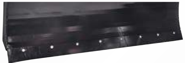
Geschraubte, hochverschleißfeste Schürfleiste (120 x 20 mm 500 HB)
