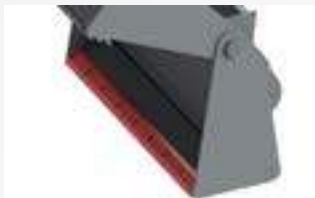
Geschraubte Schürfleiste 150 x 20 mm (500 HB) im Schaufelrücken
