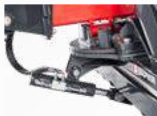
Optionale hydr. Vertikaleinstellung der Schürfleiste +/- 25°
