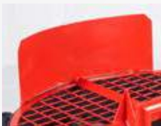
Vorderes Spritzblech zum Schutz des Traktors
