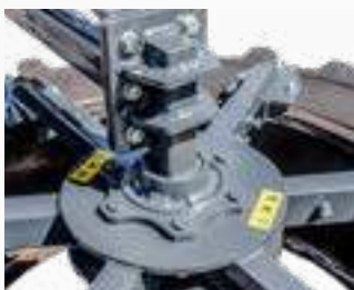
Lagerung des Kehrreifens über stabilen Achslaufstummel
