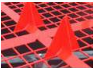
2 Aufreißerspitzen zum Öffnen von Säcken.
