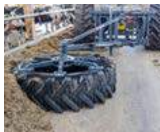
Reifendrehung durch Bodenantrieb
