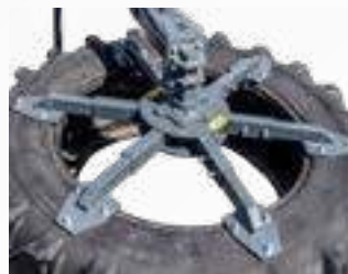
Reifenaufnahme für unterschiedliche Reifengrößen von 770 – 1.040 mm Durchmesser
