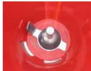
Steile Trichterwände sichern ein problemloses Nachrutschen des Streugutes. Der serienmäßige Rührkopf garantiert das störungsfreie Ausbringen von granuliertem Dünger.
