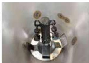
Steile Trichterwände aus Edelstahl sichern ein problemloses Nachrutschen des Streugutes. Das Rührwerk mit Kette sorgt für das Ausbringen von Salz bzw. Salz-Splittgemisch.
