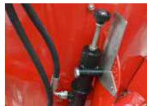
Die optionale hydraulische Schieberbetätigung ermöglicht die komfortable Einstellung der Strommenge aus der Kabine.
